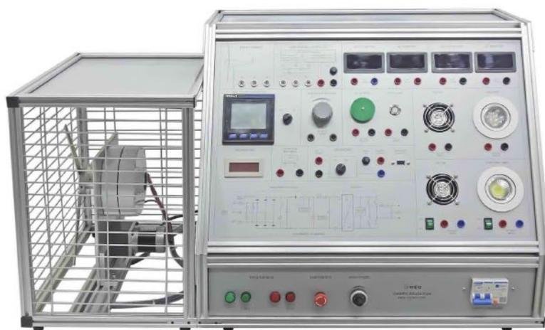
Laboratorio didattico progettato per dimostrare e studiare i principi di generazione di energia eolica. Composto da un generatore trifase a magnete permanente che converte l'energia meccanica simulata dalla turbina eolica, azionata da un motore a corrente continua con riduttore, in energia elettrica.
